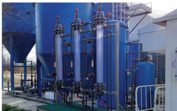
FIGURA 4. COLUMNAS CON DIFERENTES MATERIALES ADSORBENTES PARA LA CAPTACIÓN DE FÓSFORO
